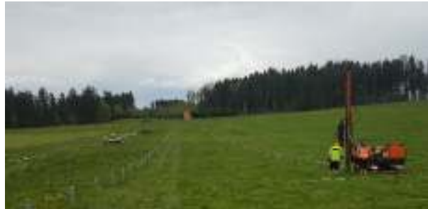
Abbildung 2: Hydraulikramme auf Ketten
